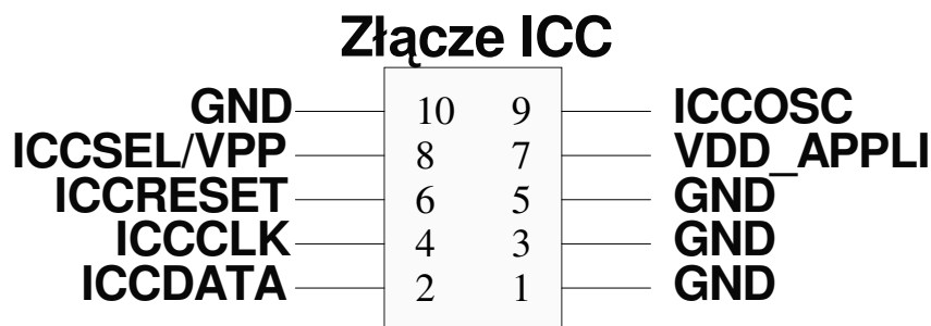
Rys.3. Przeznaczenie pinów złącza ICC
